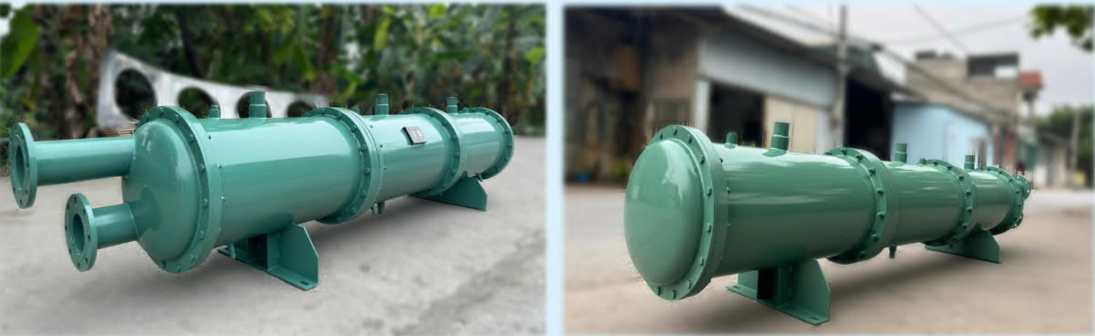
10. Sản xuất bình ngưng 3 mạch gas 180Hp (3 x 60Hp), KH công ty Cơ điện lạnh Tùng Nga, phường Vĩnh Hưng, Tp. Hà Nội
