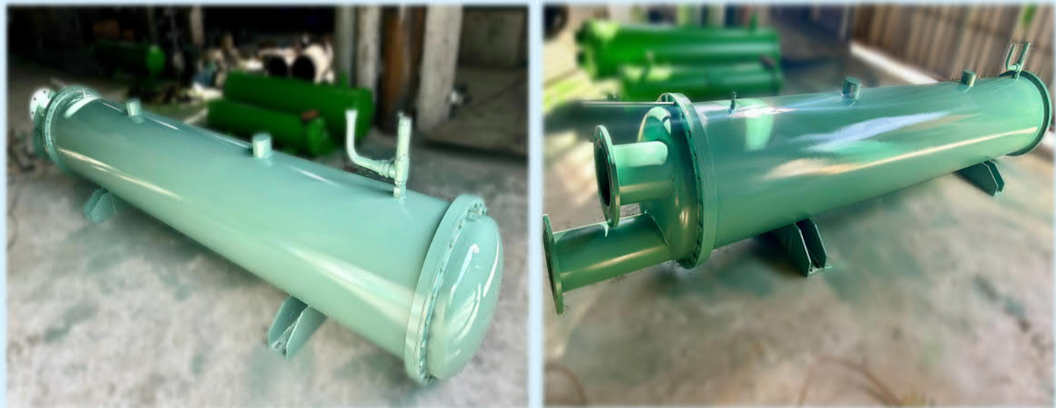
12. Sản xuất bình bay hơi 250Hp, KH công ty TMDV Sonda, Quận 12, Tp. HCM Lắp đặt tại KCN VSIP1, Thuận An, Bình Dương
