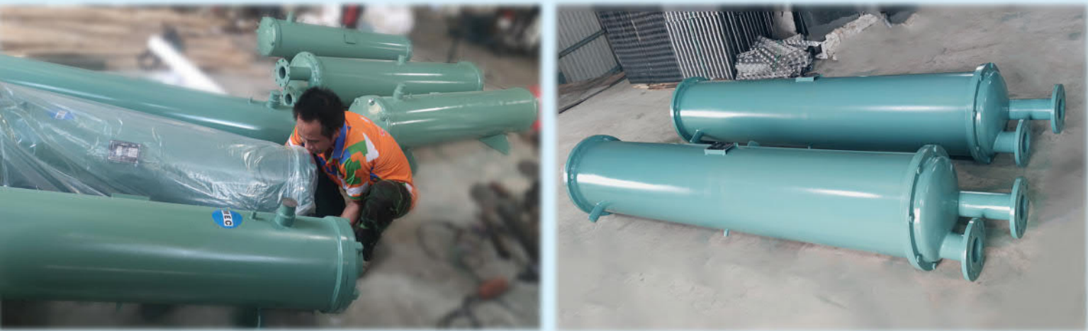
10. Sản xuất bình ngưng 3 mạch gas 180Hp (3 x 60Hp), KH công ty Cơ điện lạnh Tùng Nga, phường Vĩnh Hưng, Tp. Hà Nội
