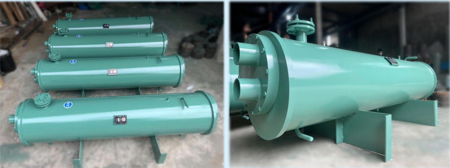
9. Sản xuất 06 bình ngưng, KH công ty TMDVCơ điện lạnh Tân Phương Tây, Quận 11, Tp. HCM
